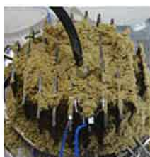
粉塵堆積試験
